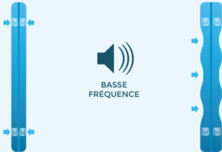
Absorption dynamique par dissipation mécanique
